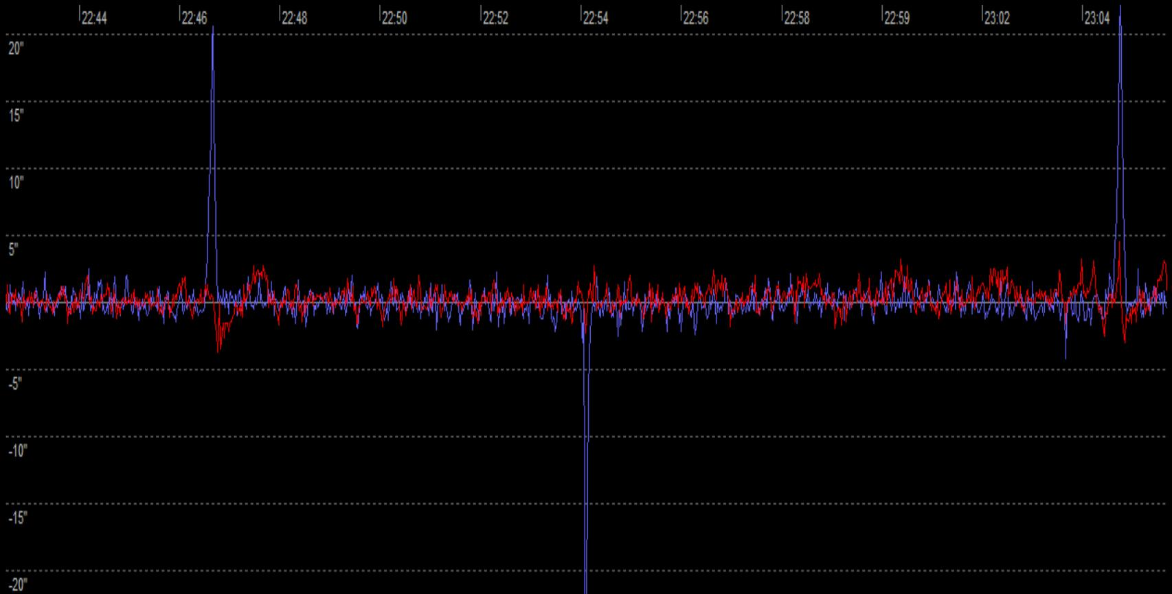
Pics dans le suivi RA – Corrigé avec un ajustement et un nettoyage du train d'engrenages
