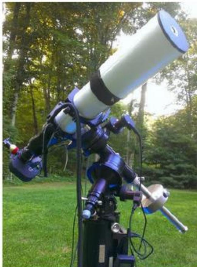
La position exacte n'est pas importante, mais 23-35 degrés au-dessus de l'horizon fonctionne bien. Cliquez sur "Drift" pour commencer à dériver.
