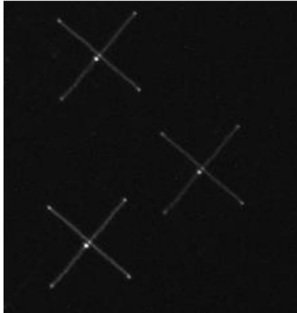
L'orientation angulaire n'a pas d'importance, c'est juste une fonction de la façon dont vous faites tourner la caméra de guidage. Ce qui est important, c'est que les lignes de la croix soient perpendiculaires et aient une longueur à peu près égale dans chacune des quatre directions par rapport au point de départ au centre. Si l'image que vous obtenez n'a pas cet aspect approximatif, le guidage sera altéré ou peut-être impossible. Par exemple, considérez le mauvais résultat suivant :
